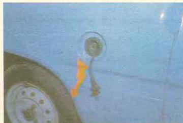
Над правым задним колесом «Оки» — гнездо для подзарядки от внешнего источника.
